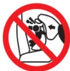
**NE JAMAIS installer cet ensemble de retenue pour enfant en position orientée vers l'arrière sur un siège de véhicule muni d'un coussin gonflable avant activé.**
