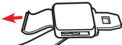
Saisir les côtés du siège là où se trouve la ceinture de sécurité, et le déplacer d'un côté à l'autre et de l'avant à l'arrière. Le siège ne doit pas bouger de plus de 2,5 cm (1 po).
