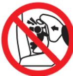
**NE JAMAIS installer cet ensemble de retenue pour enfant en position orientée vers l'arrière sur un siège de véhicule muni d'un coussin gonflable avant activé.**
