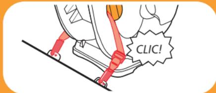
**6. S'assurer que la base est au moins à 80 % sur le siège du véhicule.**
