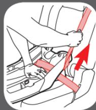
**Remarque:** Avec la ceinture de siège du véhicule en mode verrouillé, toute la tension se trouve transférée vers le haut dans la ceinture diagonale. Cela peut faire basculer le siège d'auto vers le côté. Si cela se produit, utiliser une agrafe de verrouillage au lieu d'actionner l'enrouleur automatique. Consulter la rubrique sur la plaquette coulissante et le rétracteur à verrouillage d'urgence (ELR).
