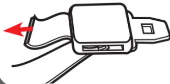
Saisir les côtés du siège là où se trouve la ceinture de sécurité, et le déplacer d'un côté à l'autre et de l'avant à l'arrière. La base ou le siège ne doit pas bouger de plus de 2,5 cm (1 po).
