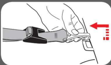
**3. Pousser le crochet vers l'intérieur, le soulever et le tirer vers l'extérieur en l'éloignant du point d'ancrage.**
