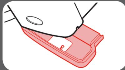
Si nécessaire, placer des serviettes roulées ou d'une nouille de piscine sous la base, à l'angle du siège et du dossier du véhicule, jusqu'à ce que la ligne indicatrice du niveau soit parallèle au sol.
