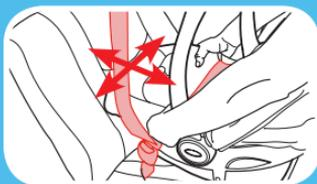
Le siège d'auto ne doit pas bouger de plus de 2,5 cm (1 po) au niveau du passage de la ceinture
