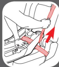
**Remarque:** Avec la ceinture de siège du véhicule en mode verrouillé, toute la tension se trouve transférée vers le haut dans la ceinture diagonale. Cela peut faire basculer le siège d'auto sur le côté. Si cela se produit, utiliser une agrafe de verrouillage au lieu d'actionner l'enrouleur automatique. Consulter la rubrique sur la plaquette coulissante et le rétracteur à verrouillage d'urgence (ELR).
