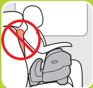
3. **NE PAS UTILISER** si l'appui-tête du siège du véhicule se superpose au siège du véhicule et pousse la tête de l'enfant vers l'avant dans une position non naturelle
