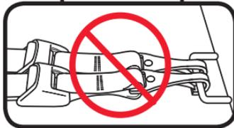
**! Ne jamais attacher deux crochets du SAU au même POINT d'ancrage inférieur du véhicule à moins que cela ne soit clairement permis par le fabricant du véhicule.**
