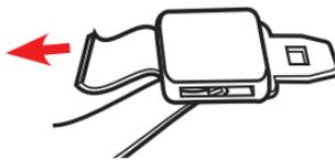
Saisir les côtés du siège de retenue pour enfant là où se trouve la ceinture de sécurité, et le déplacer d'un côté à l'autre et de l'avant à l'arrière. La base ou le siège ne doit pas bouger de plus de 2,5 cm (1 po).
