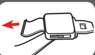
Saisir les côtés du siège de retenue pour enfant là où se trouve la ceinture de sécurité, et le déplacer d'un côté à l'autre et de l'avant à l'arrière. La base ou le siège de retenue pour enfant ne doit pas bouger de plus de 2,5 cm (1 po).
