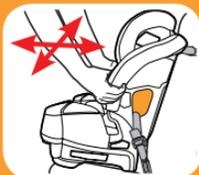
***Le siège de retenue pour enfant ne doit pas se déplacer de plus de 2,5 cm (1 po) au niveau du passage de la ceinture.***
